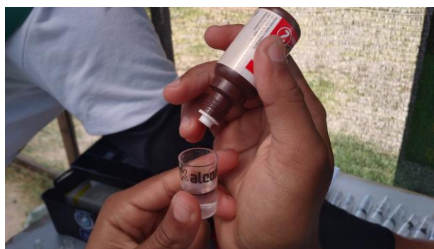
Figura 43: Adição do reagente 2 para teste de nitrito
