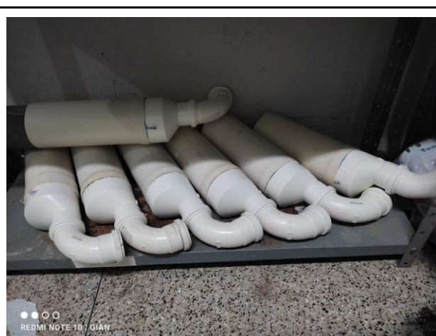
Figura 53: Estruturas internas do pré-filtro montadas
